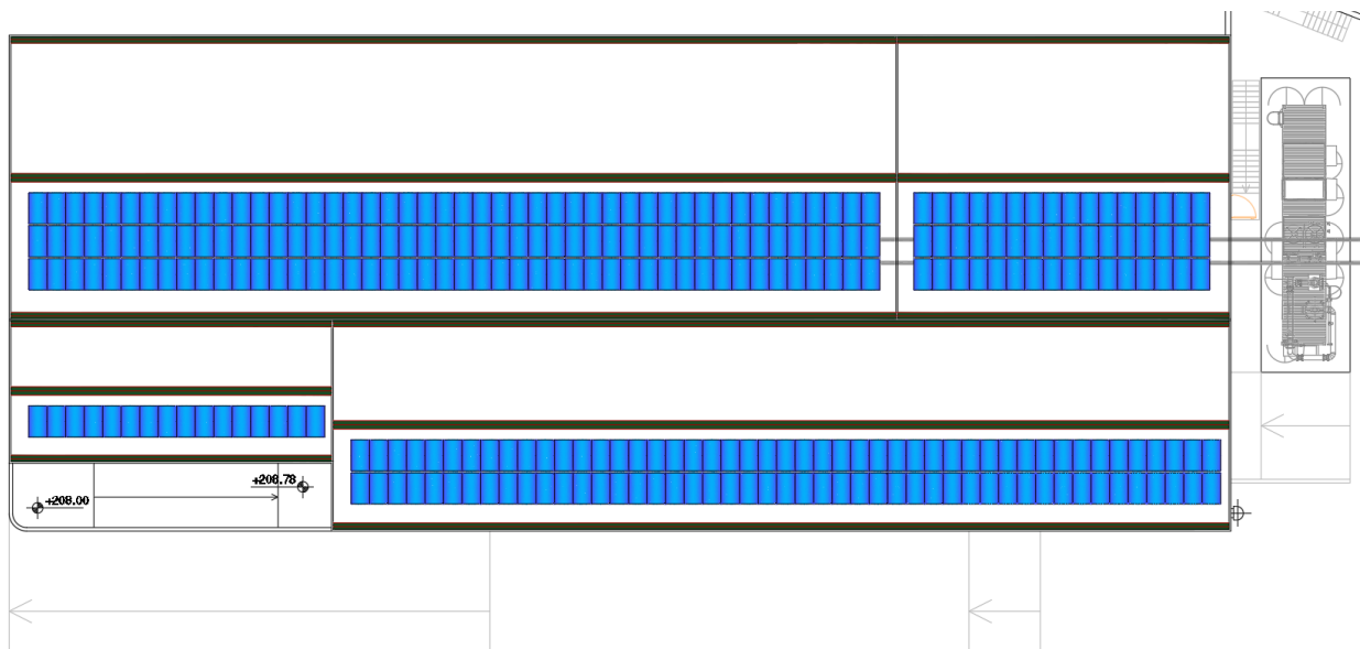
Figura 1 Fotovoltaico in copertura Edificio ricezione e pretrattamento
